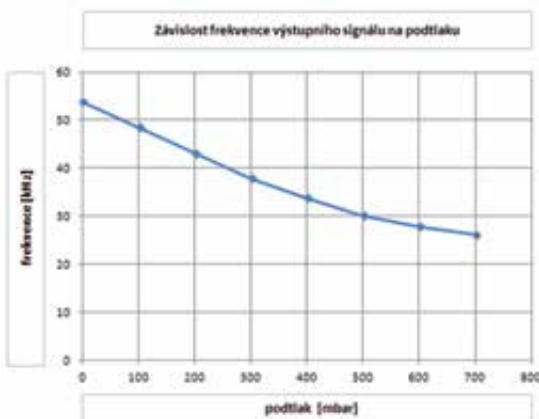
Obr. 5 Závislost frekvence signálu snímače podtlaku na vstupním podtlaku
