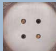
Destička s otvory po čištění: část úsad nebylo možno odstranit
