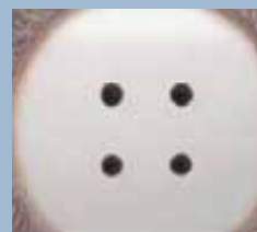
Čistá destička s otvory v novém vstříkovacím ventilu
