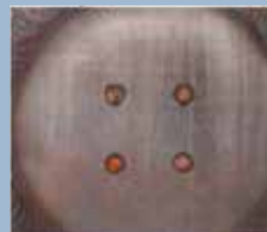
Znečištěná destička s otvory ve vstříkovacím ventilu před čištěním
