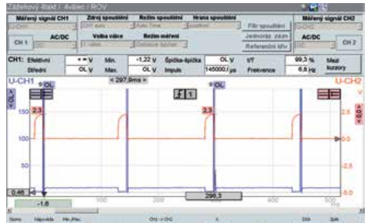
Obr. 6 Signály spínání koncového tranzistoru pro primár cívk a řídicí impulzy do jeho báze
