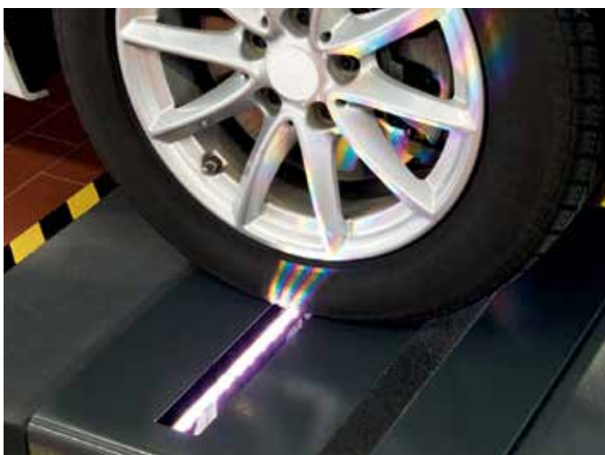
Měřicí technika je založena na barevném kódování - žádné pohyblivé díly, necitlivost vůči prachu, vibracím a vlhkosti
