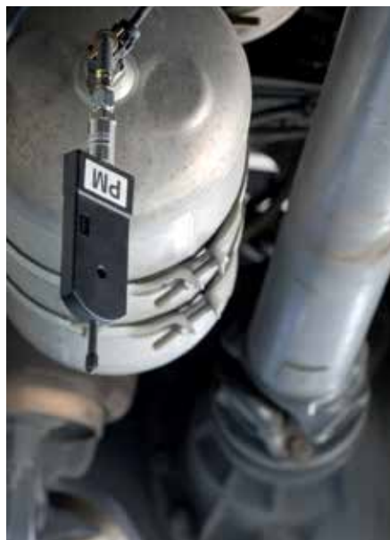
Rádiem řízené senzory tlakového vzduchu
