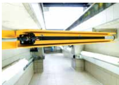
PSC1, podélné zajištění montážní jámy
