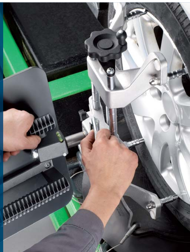
Jednoduchá montáž – je nutné pouze jedno seřízení tabulí
